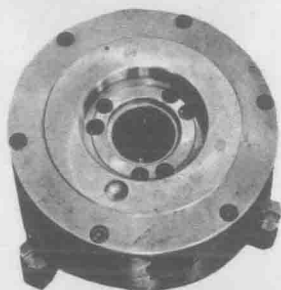
▲直裝式螺旋夾頭之後面，凸緣式主軸端
