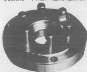
▲凸輪固緊式附件。外邊三個孔是夾頭裝置用且不需要多餘之附件，例如新夾頭、特別四爪單動夾頭是如此，這稱為“直裝式”。
