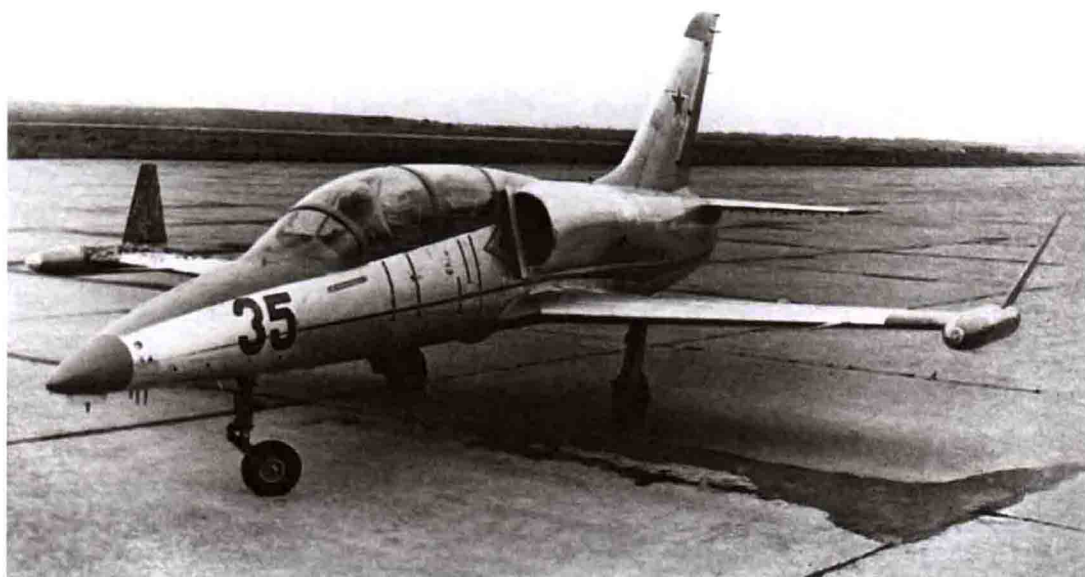
停放在茹科夫斯基的停机坪上，由LII设计安装了翼梢小翼的“35”号L-39C试验机。
