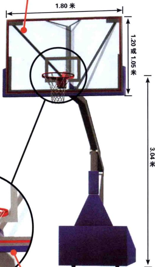
◆ **篮筐**：固定在支撑篮板的结构架上，使任何施加在篮筐上的力都不会传递到篮板上。
