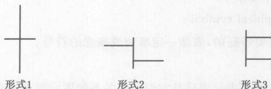
图 1-3 “半导体区,具有多处接触”的三个形式
