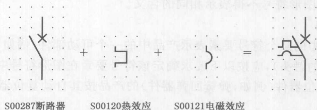
图 1-8 用热和电磁效应符号限定断路器符号示出的微型断路器
