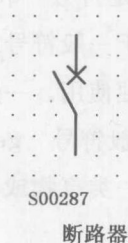
图 1-4 用断路器符号示出的微型断路器
