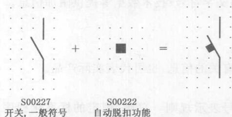
图 1-5 用自动脱扣符号限定开关一般符号示出的微型断路器
