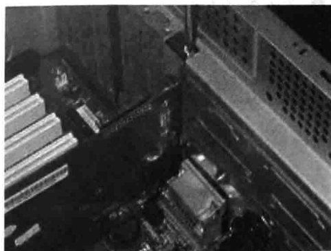
图 1-36 拧掉显卡固定螺丝
