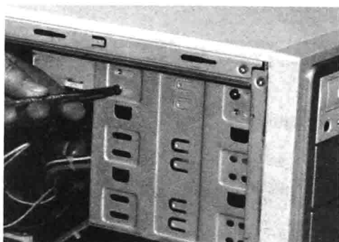
图 1-32 拧掉光驱固定螺丝
