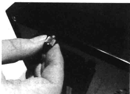
图 1-21 拧开机箱固定螺丝
