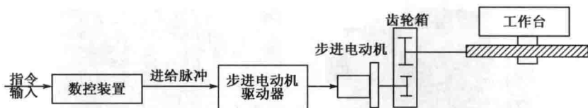
图 1-11 开环控制系统框图
