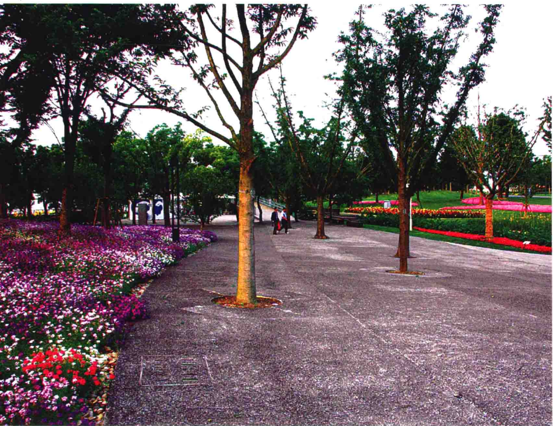
■ 上海世博公园透水地面——无砂混凝土
