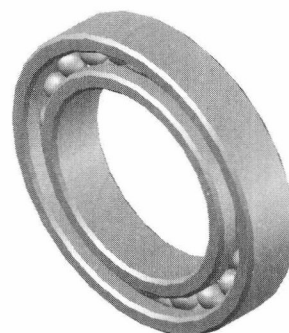
实例名称 【练习24-3】：创建滚动轴承 技术掌握 阵列三维模型的方法
