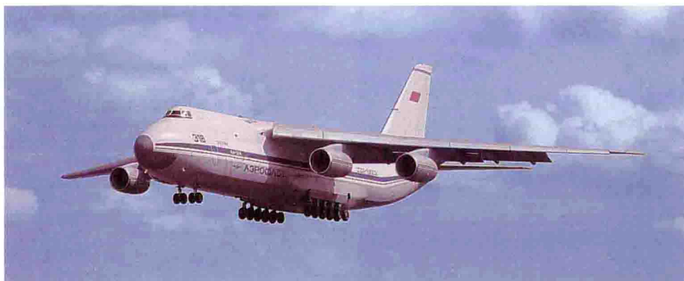
上图：近距离能清楚地看到安-124的多轮着陆起落架和双机头轮组。
