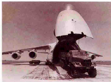
上图：尽管打开机头需要整整7分钟，但安-124能从机头和机尾同时装载。装卸坡使装载车辆变得方便快捷。前后两个装卸坡都能承受70000千克主战坦克的重量。
