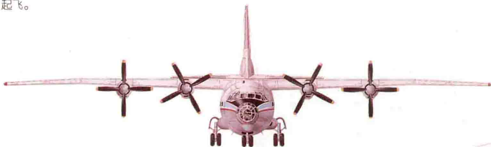
上图：安-12安装了4台伊弗琴科AI-20的涡轮螺旋桨发动机，发动机产生的热空气可用于除去机翼和机尾上的冰层。
