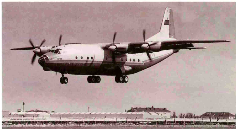
上图：安-12装有长长的襟翼和低压轮胎，甚至重载时也可以在不很平整的跑道上安全降落。
