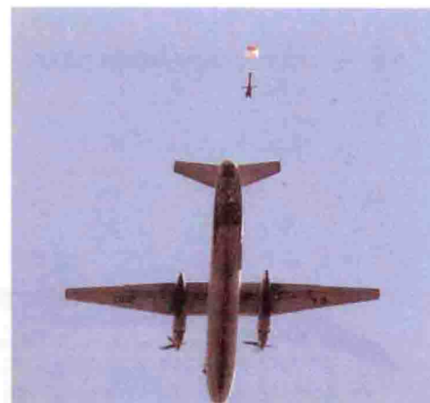
下图：大型尾舱门和圆顶观察窗的设计，使安-26适用于部队伞投。
