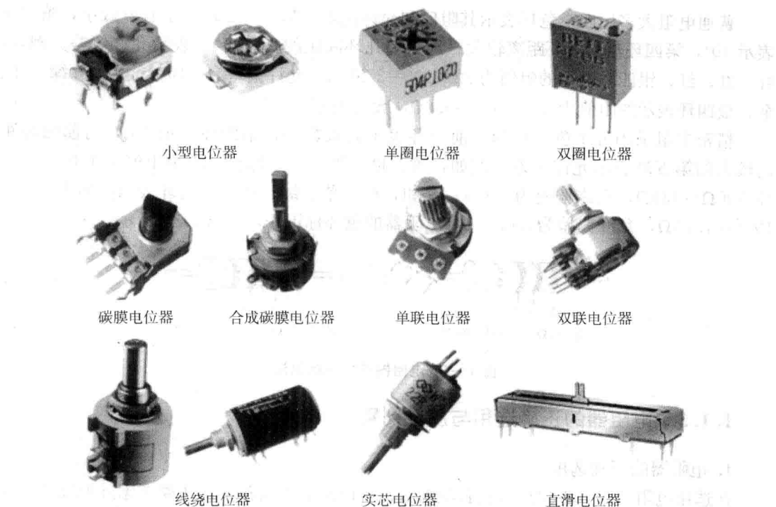
图 1—6 常用的电位器外形
