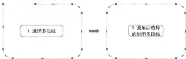
图 1-8 圆角方式创建封闭多段线
