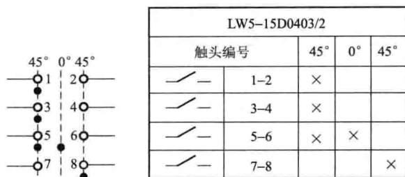
图 1-12 转换开关电气图文字符号
