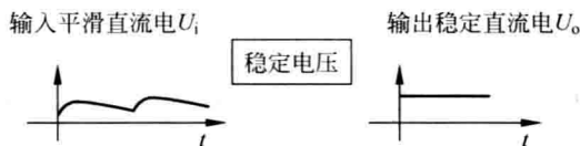
图 1.20 稳压电路波形
