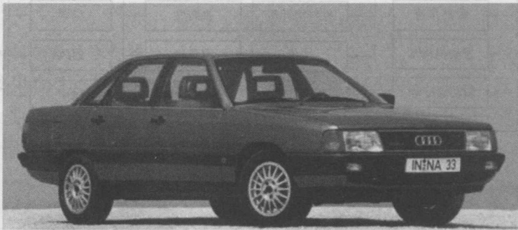
图 1-25 1982 年奥迪 100C3 以 C_D 为 0.30 创造了轿车空气动力学的世界纪录
