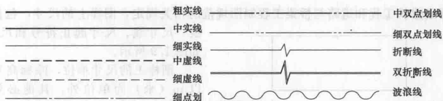
图 1.7 常用道路与桥梁 CAD 制图图线
