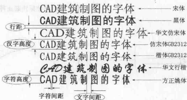
图 1.8 道路与桥梁 CAD 制图字体间距
