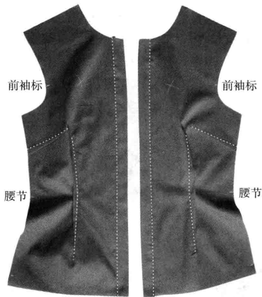
图1-1-8 腋下省女衬衫前片缝制工艺
