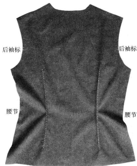
图 1-1-9 腋下省女衬衫后片缝制工艺
