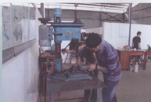
通用技术教师在练习使用 台钻完成工件加工
