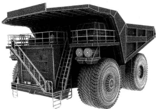
图 1.1 大吨位交流传动电动轮自卸车
