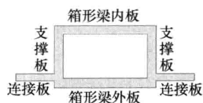
图 2 单个箱形梁模型图
