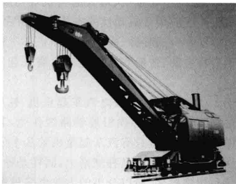
图 1-1 Z601 型 60 t 蒸汽铁路救援起重机
