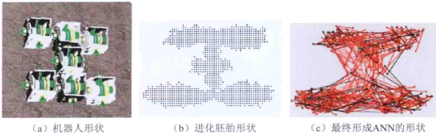
彩图 14 结构化 ANN 的进化。图 (a) 为给定的机器人形状，它是人工进化过程适应度函数的一部分。图 (b) 是虚拟胚胎的进化形状，它们组成了 ANN 网络拓扑。图 (c) 是一种 ANN 拓扑的例子，它由该胚胎生长而来（参见内文 p. 44）
