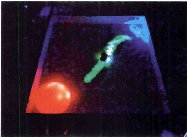
彩图 8 机器人在 1\text{ m} \times 1\text{ m} 的场地中、食物源（右上方）和出发点（左下方）间 1.3\text{ m} 的距离上铺设的路径。图中的机器人正在从食物源指向出发点的返回路上，而且它遵循其自身的路线（参见内文 p. 38）
