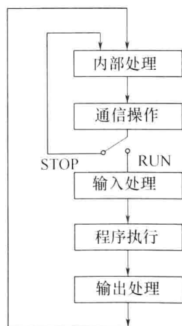
图 1.1-10 PLC 的工作过程
