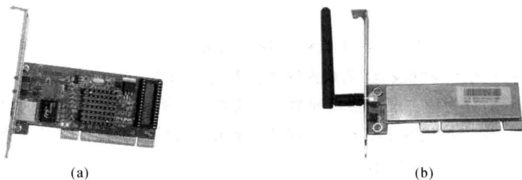
图 1-2 有线网卡和无线网卡 (a)RJ-45 双绞线接口网卡;(b)无线 PCI 网卡
