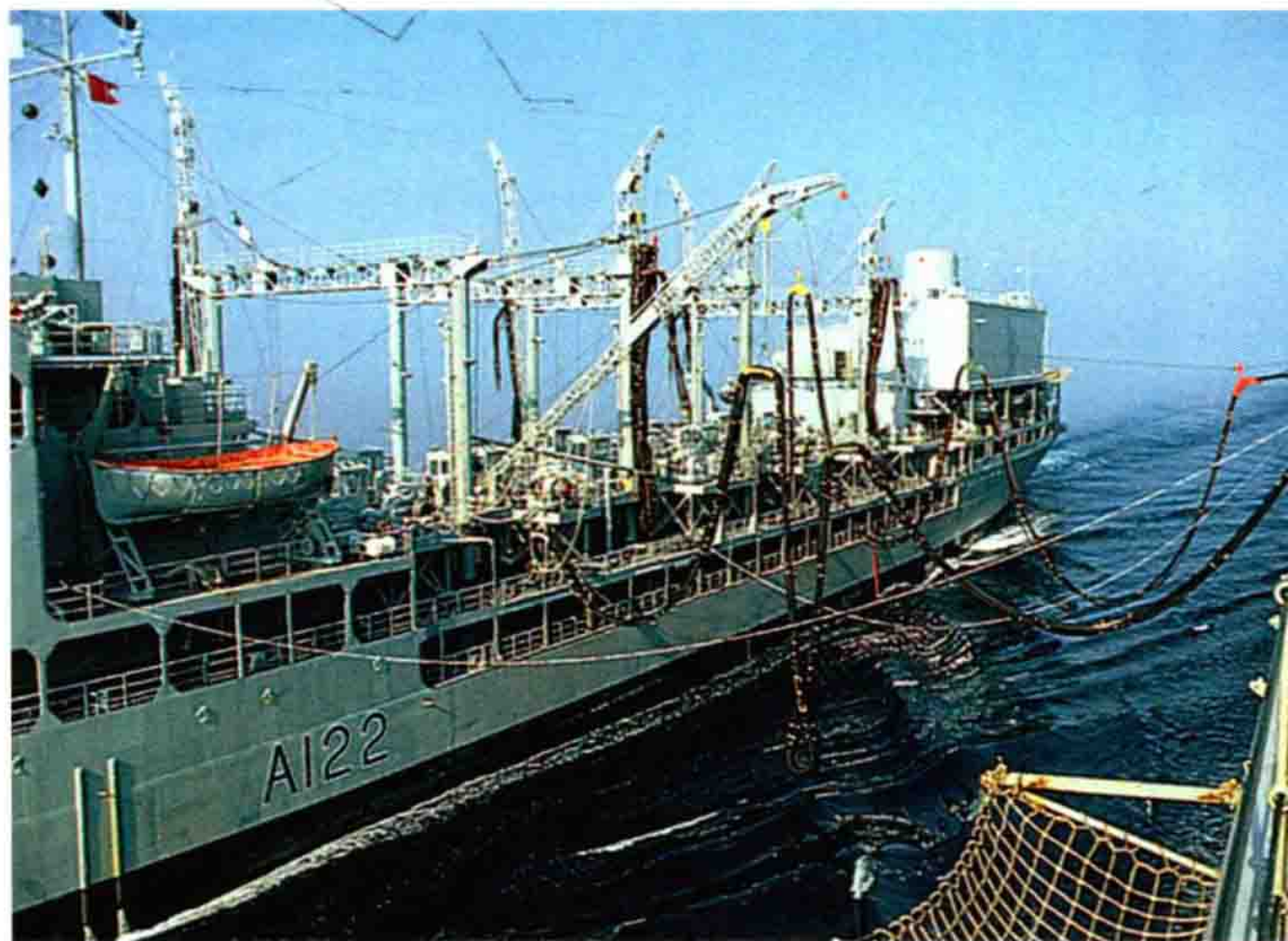
在海上，不需要停船就可以给舰艇补给燃料。图中英国皇家海军辅助舰队的“欧文”号，正在通过悬在两船之间的管道向另一艘皇家海军舰艇的船舱内直接输送燃料、油和水。
