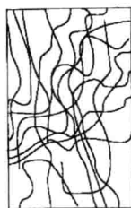
(a) 取向度和结晶度较低纤维结构
