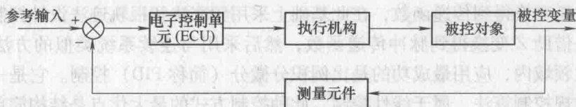
图 1-3 闭环控制系统的原理框图
