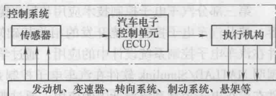
图 1-1 汽车电子控制系统的基本概念
