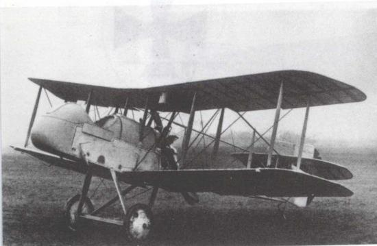
式发动机，在飞机机头的旋座上安装1挺“路易斯”式机枪，这种旋座装置可使机枪上下左右转动。在试验中，飞行员发现这种安排很不稳定，就把机枪固定在一个前射位置上，以整架飞机作为瞄准平台。DH-2型飞机的结构坚固并具有高度的灵活性，在与“福克”式战斗机的对阵中，它比协约国其他任何一种战斗机都取得了更大的成功。
