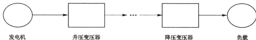
图 1-1 电力系统结构示意图
