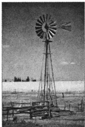
图 1-1 风力提水装置
