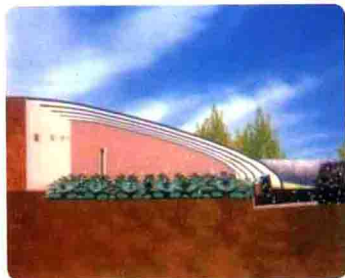
外置秸秆生物反应堆产生 \text{CO}_2 ，通过地道、交换机进入大棚。
