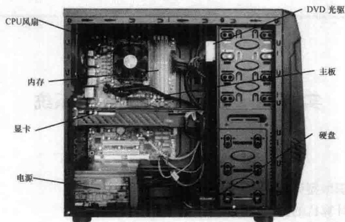
图 1-2 主机内部结构
