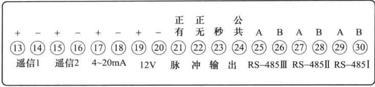
图 2-6 I 型集中器辅助接线端子示意图 (带交流采样)
