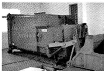
图6 垃圾压缩设备
