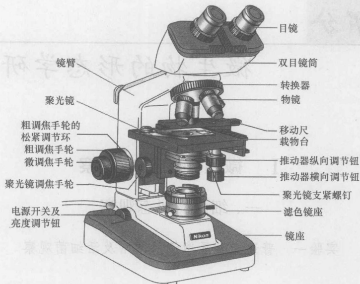
图 1-1-1 普通光学显微镜的构造
