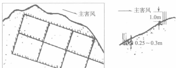
图 1.5 方格沙柳沙障工程示意图
