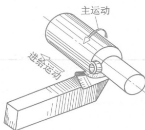
图 1-1 车削时的切削运动
