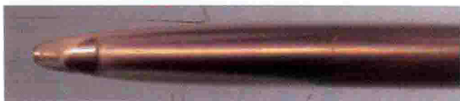
图 4.27 通气碗直径太大引起的空泡不连续实验照片
