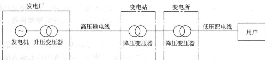
图 0-1 电力传输的过程
