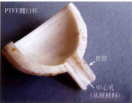
图 1.7 块上原有中心钻孔沿髌臼杯的中心轴钻通
