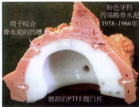
图 1.2 横截面观察从骨水泥中取出的受损植入物
