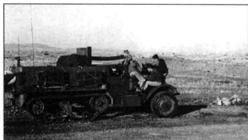
▲ 这辆M9半履带车在隔间上有一门20mm自动加农炮（根据租借法案，很多欧洲国家都拥有大量美制M2/3系列半履带装甲车，而在战争结束后，这些装甲车的大部分都成了剩余军用物资，于是这些剩余军用物资也就成了以色列坦克部队在1948年战争中的主力装备。事实上，由于这些可以加装一些在其他装甲车上无法安装的重武器，这些美制半履带装甲车发挥的作用远远超过了有限的几辆坦克）
