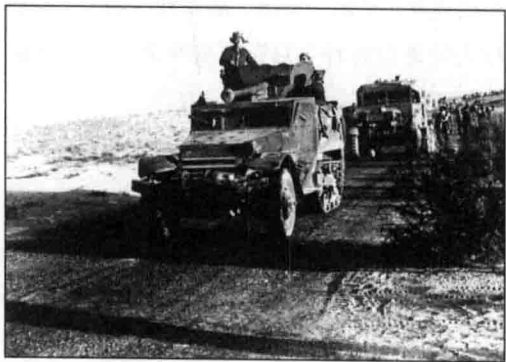
▲ 由于缺少坦克，以色列第82装甲营同样不得利用其他车辆作为补充。图中的这辆M3半履带装甲人员输送车就在安装了一门缴获的6磅反坦克炮后，被作为坦克或是坦克歼击车使用（有意思的是，图中的这辆车很典型地展现了当时以色列改进半履带车的一贯特点——在驾驶室的右边加装一把机枪）
