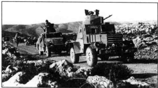
▲ 由于缺少足够的装甲车，以色列部队甚至还临时拼凑了一些代用车辆，图中的这辆装甲车实际上是由一辆道奇两吨半卡车改装而来，此时它正跟着一辆改造过的M3A1侦察车进行战斗巡逻
