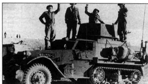
▲ 这是另一辆经过改装的M9半履带车，安装在大型炮塔中的很可能是一门小口径自动加农炮（很少有人意识到的是，这些本属权宜之计的代用品，以色列后来使用了足足30年）
