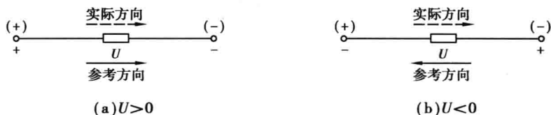
图 1.3 电压的参考方向与实际方向
