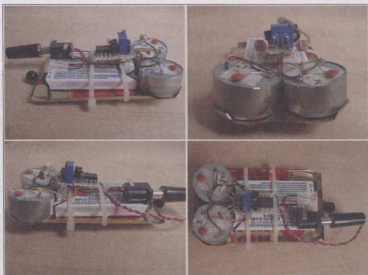
图1-5 业余制作可以尽情发挥创意，使用任何可以利用的材料。这是一个以铁罐头皮为底盘制作的寻光机器人。两只电机固定在底盘上，尾轮是一个塑料珠子，电源是淘汰下来的手机电池，电子部分焊在一小块洞洞板上，用尼龙扎带把这些捆绑在一起，就构成了一个智能移动平台，是不是很有趣？
