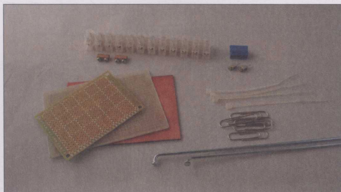
图 1-10 机器人的结构材料：3mm 接线端子、洞洞板、尼龙扎带、曲别针、车条
