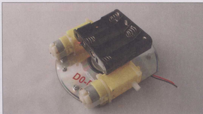
图 1-11 把两片光盘叠起来，用 M3 螺丝固定好，电机和电池盒用尼龙扎带和热熔胶固定
