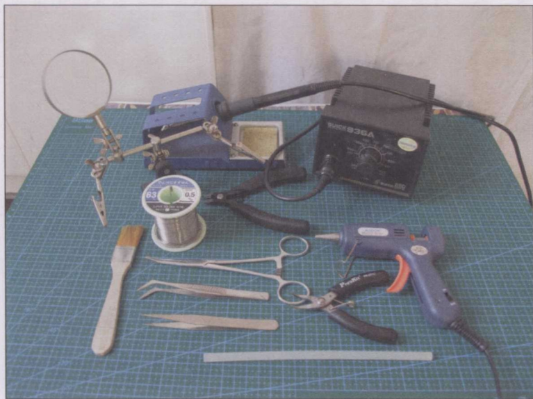
图1-15 制作机器人电子部分经常用到的工具
