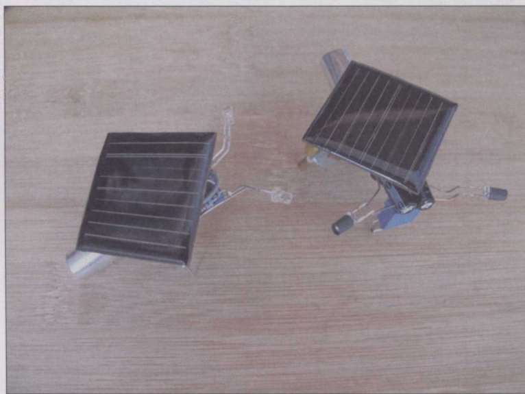
图 1-1 直接使用电子元器件作为骨架制作而成的两只太阳能蟋蟀
