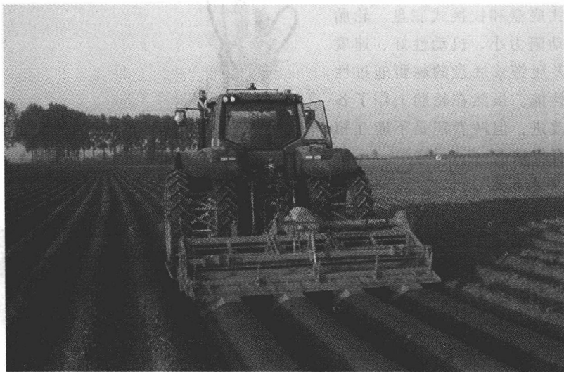
图 1-3 采用专用底盘的拖拉、打埂、播种机
