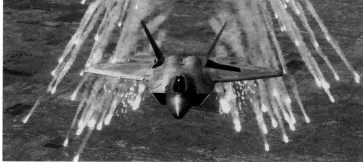
↑ F/A-22A正在投下曳光诱饵弹。诱饵弹的发射位置于主起落架舱的正后方。
