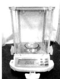
使用稱量瓶稱取 \text{NaOH} 2gm
