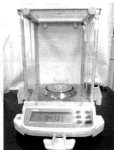
使用稱量瓶精稱 \text{C}_6\text{H}_4\text{COOKCOOH} (約 0.4g) (三重複)
