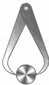
(a) 外卡钳测量外径
