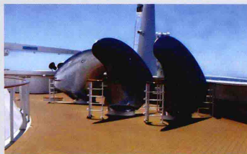
安装在前甲板的8台备用螺旋桨叶的其中3台
