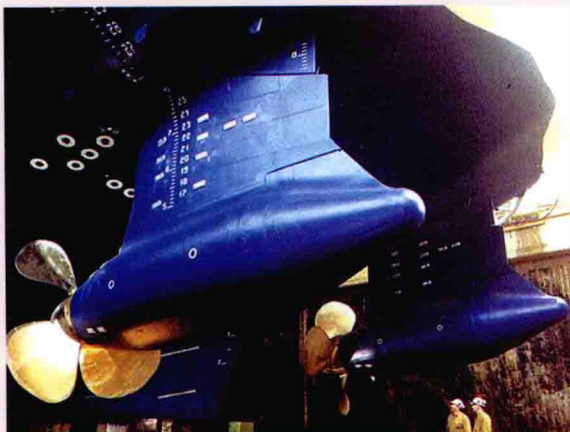
Carnival Elation和Carnival Paradise上的 2 \times 14 MW Azipod装置
