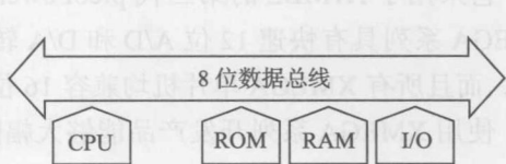
图 1-2 “冯·诺依曼”结构的单片机内部结构
