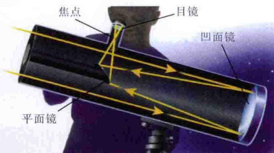
B 反射望远镜中,光线透过凹面镜聚焦成像。
