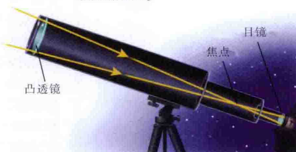
A 折射望远镜中,光线透过凸透镜聚焦成像。
