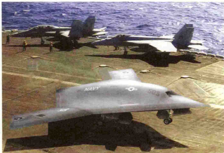
下图：一架21世纪海军型无人作战飞机（UCAV-N）降落在一艘航空母舰甲板上。这里可以看到，诺斯罗普·格鲁曼公司用他们带有“飞翼”的X-47A“天马”试验型无人机成功地验证了这种综合了“风筝”特性的气动外形布局。这种设计能提供长航时、高生存性以及出色的从航母上起飞和回收的飞行特性。（诺斯罗普·格鲁曼公司媒体关系部）
